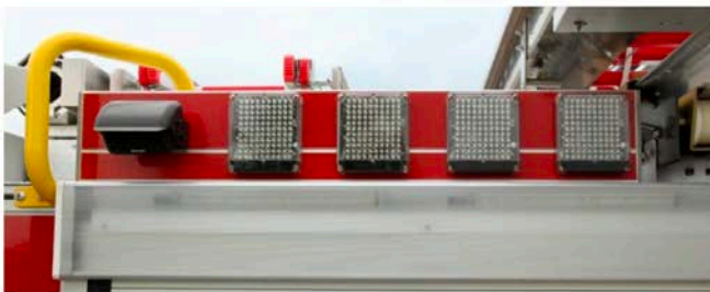
Ejemplo de instalación de la cámara de marcha atrás en la parte trasera del vehículo
