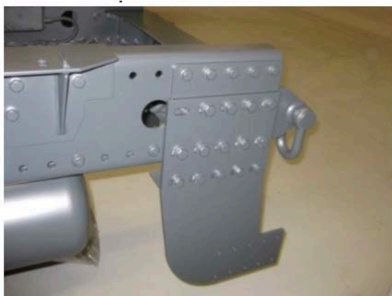
Ejemplo de revestimiento/sellado de los bajos en el extremo del bastidor
