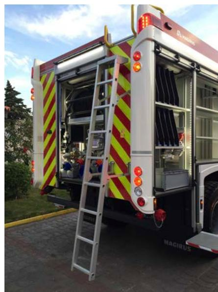
**9.8 LUCES DE COMPARTIMIENTOS:** Iluminación LED que se activa con la apertura de las cortinas, incluidas en la garantía y de fácil reparación. Abarcan al menos el 75% de altura del compartimentó y vienen instaladas en ambos lados.
