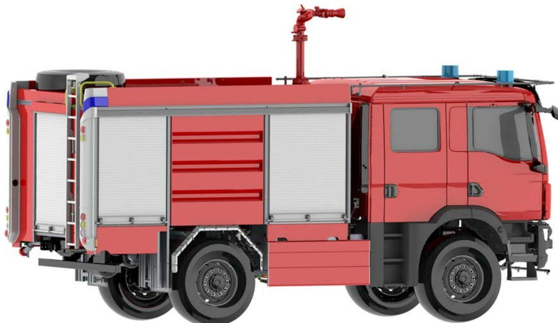
**9.1 Estructura Principal:** Carrocería completamente en perfiles de aluminio extruido y anodizado reforzado ensamblado por piezas de unión, mantenida por visaje, y paneles de aluminio pegados
