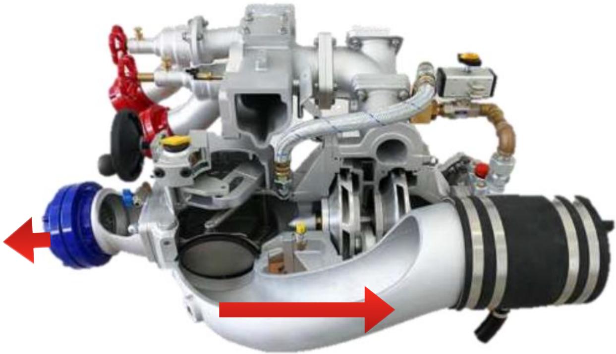
Flujo del exceso de presión.
